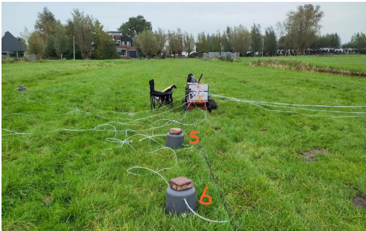
Figuur 2-4 Voorbeeld van de meetopstelling. Twee diffusiekamers geplaatst midden tussen de sloot en de greppel.
