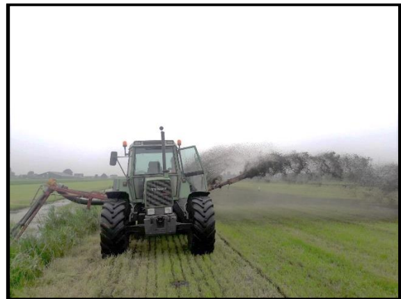
Baggeren met de baggerpomp
